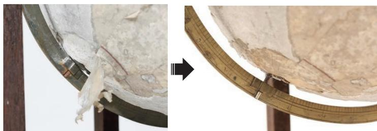
地球儀の南極付近は地軸固定部分が緩み、軸が落ち込んで緯度尺にあたっていました。また、彩色層の一部は浮いている状態でした。
