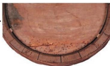
底板は経年による寸法変化のため、抜け落ちてしまう危険性がある状態でした。
