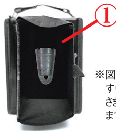
▲図2 レンズの裏側 ピントフード付きのすりガラス
